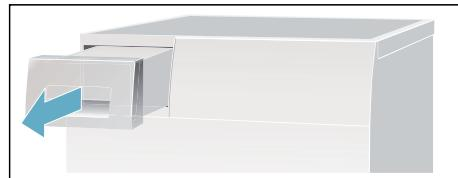
2. Vaciar el agua condensada.
